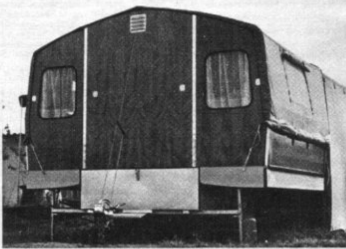
Trostpflaster für kleine Zugwagen: Der Klapp-Anhänger! Hier das „Brüderchen“ von Scholz in Köln, Am Zuckerberg 8, das aufgebaut schon mehr ein großer Bruder ist. Sehr ausgereift, sehr gut durchdacht, voll campingtauglich und sehr fahrsicher. Mit einem Spezialträger kann oben auf noch ein Boot befördert werden. Fahrbreite 148 cm, Fahrhöhe 96 cm, Eigengewicht 240 kg, Preis (komplett) 3 328 DM.
